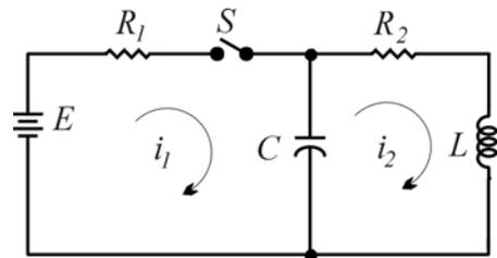
$$\begin{bmatrix} \dot{x}_1 \\ \dot{x}_2 \end{bmatrix} = \begin{bmatrix} -\frac{1}{R_1 C} & -\frac{1}{C} \\ \frac{1}{L} & -\frac{R_2}{L} \end{bmatrix} \begin{bmatrix} x_1 \\ x_2 \end{bmatrix} + \begin{bmatrix} \frac{1}{R_1 C} \\ 0 \end{bmatrix} E$$
