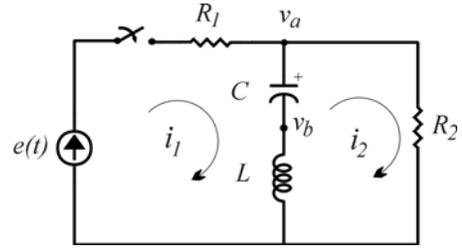
$$\begin{bmatrix} \dot{x}_1 \\ \dot{x}_2 \end{bmatrix} = \begin{bmatrix} 0 & \frac{1}{C} \\ -\frac{1}{L} & -\frac{R_1 R_2}{L(R_1 + R_2)} \end{bmatrix} \begin{bmatrix} x_1 \\ x_2 \end{bmatrix} + \begin{bmatrix} 0 \\ \frac{R_2}{L(R_1 + R_2)} \end{bmatrix} e$$
